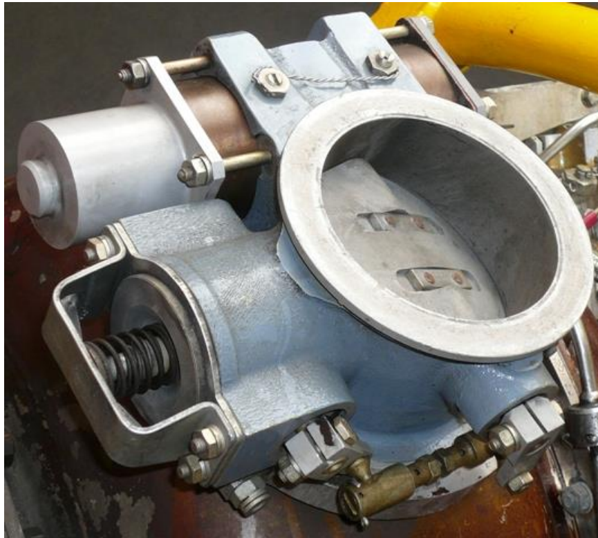
Compressor bleed valve (Palouste)
